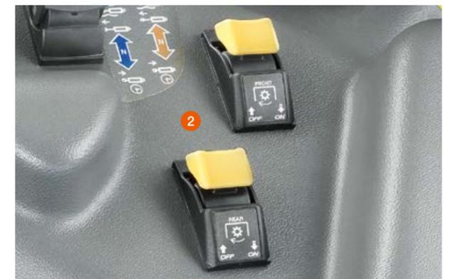
2 Front- und Heckzapfwelle lassen sich mit einem Knopfdruck einfach aktivieren.
