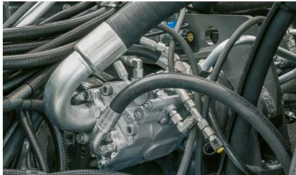
Hydraulikleistung bis zu 442 l/min.
