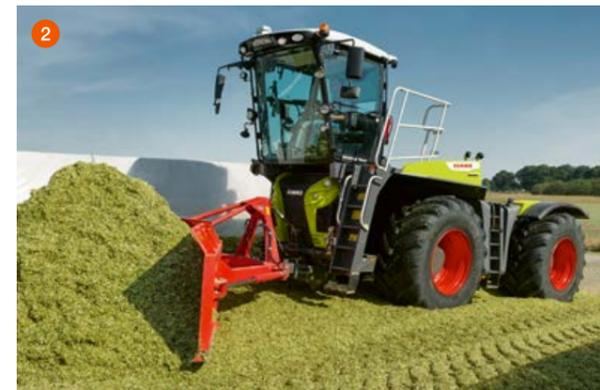
Wenn Sie ein Schiebeschild in der Front des TRAC, TRAC VC oder SADDLE TRAC einsetzen wollen, können Sie ihn mit einem verstärkten Frontkraftheber (2) ausstatten. Damit schieben Sie Silage auf einer Breite von bis zu 4 m. Scherschrauben schützen den Kraftheber vor Überlastungen.
