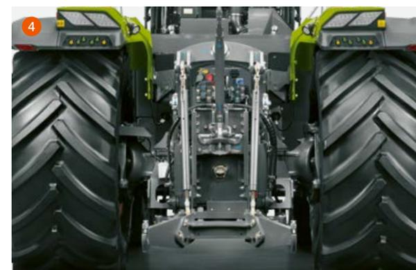
Für den SADDLE TRAC ist ein schwenkbarer Heckkraftheber (4) erhältlich. Er ermöglicht ein bodenschonendes, spurversetztes Fahren auch dann, wenn Sie z.B. auf empfindlichen Grünlandflächen Gülle ausbringen wollen.
